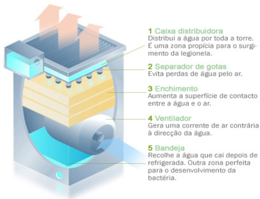
Figura 6: Descrição das partes de uma instalação
